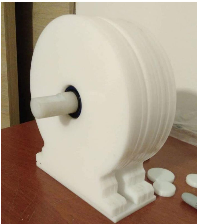
Figure 87. Motor de flujo axial ensamblado.
