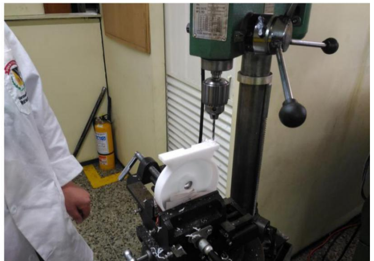
Figure 88. Mecanizado de agujeros para soporte del motor.
