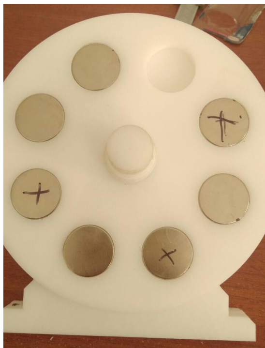
Figure 83. Montaje de magnetssobre el rotor.
