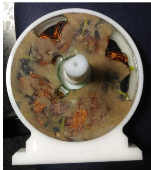
Figure 97. Bobinas embebidas en resina epoxy.
