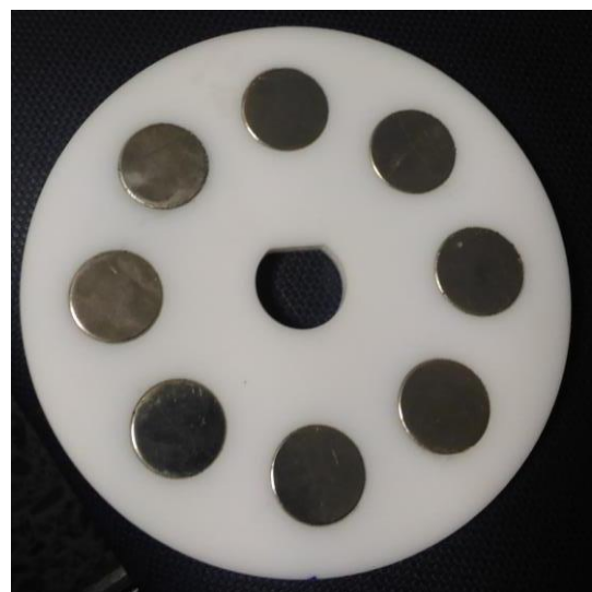
Figure 98. Montaje final del rotor con imanes.
